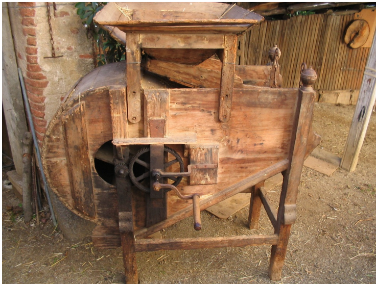
Una vella ventadora de Can Cisa, per separar el gra de la pellofa.
